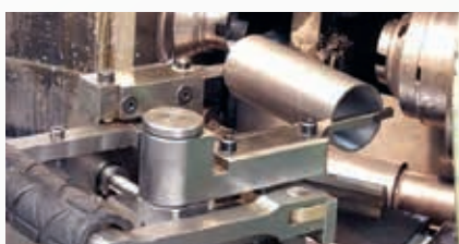
تجليخ سطح حركة حلقة المكبس
